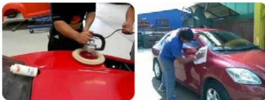
Ilustración 5: Pulido del Vehículo
