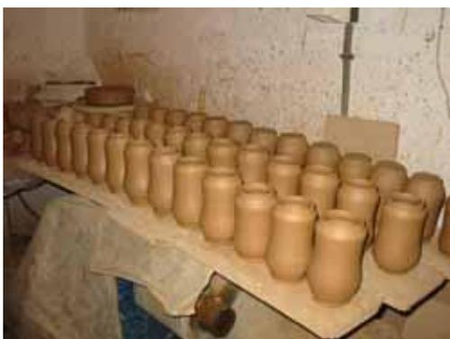
**LAS PIEZAS DE CERAMICA YA SECAS SE METEN EN EL HORNO Y SE CUECEN A 1.060 GRADOS DE TEMPERATURA**
