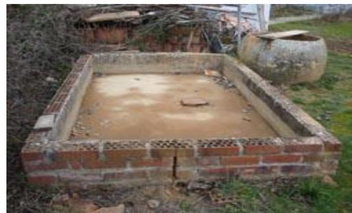
**DESPUES SE VA ECHANDO EL BARRO A UNA FUENTE PASANDOLO POR UN CEDAZO PARA QUE EL BARRO QUEDE TOTALMENTE LIMPIO Y SE PUEDA LUEGO TRABAJAR BIEN CON EL, SE DEJA EN LA FUENTE HASTA QUE SE EVAPORE EL AGUA Y SE PUEDA RECOGER**
