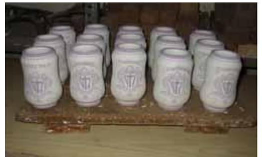
POR ÚLTIMO SE VUELVEN A METER EN EL HORNO Y SE CUECE A 950 GRADOS DE TEMPERATURA Y YA SALE TOTALMENTE TERMINADA LA PIEZA, PREPARADA PARA SU COMERCIALIZACIÓN.
