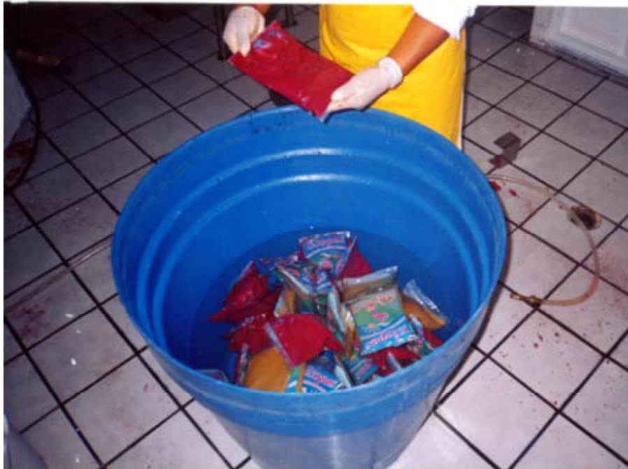
TINA DE ENFRIAMIENTO DE PULPA ENFUNDADA.
