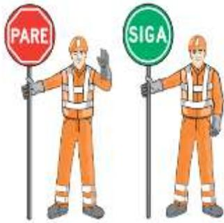
Cuando a lo largo de una zona de trabajos, sólo es posible permitir la circulación de vehículos en un sentido, en forma alternada, se debe asegurar que exista una coordinación tal en el derecho de paso que evite accidentes y demoras excesivas. Ello se logra mediante sistemas de control de tránsito. El sistema de control de tránsito debe: otorgar derecho de paso alternadamente;
