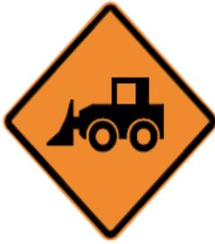
Esta señal se utiliza para advertir sobre la presencia de maquinaria en la zona de trabajo, la que generalmente circula a baja velocidad o puede encontrarse entrando o saliendo de la vía. Su ubicación con respecto a los sectores donde entran o salen dichos vehículos pesados depende de la velocidad máxima permitida en la zona de trabajo.
