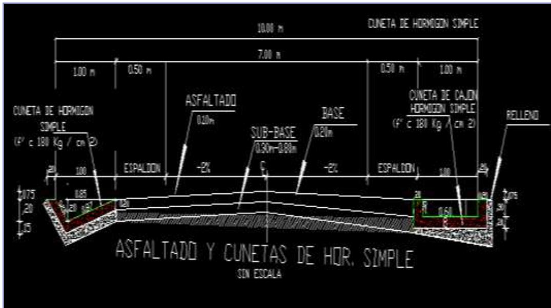
**Figura 4-3: Diseño de cunetas**
