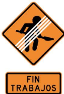
Esta señal se utiliza para indicar que la circulación a través de la zona de trabajos ha concluido y se restablecen las condiciones que existían antes de ella. Se debe instalar a no menos de 120 m del punto donde finaliza el área de seguridad, en vías rurales, y a no menos de 25 m cuando se trata de vías urbanas.
