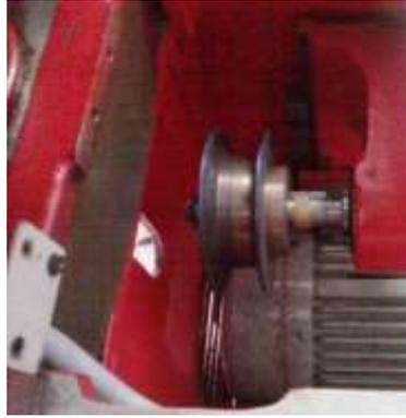
Figura 4.17. Polea de transmisión.
