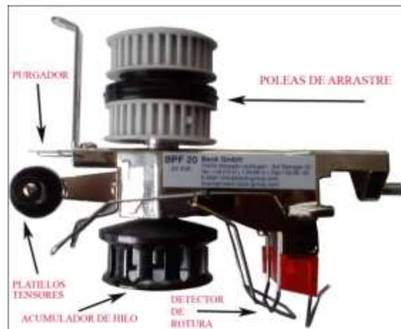
Figura 3.8. Partes y componentes del alimentador positivo.
