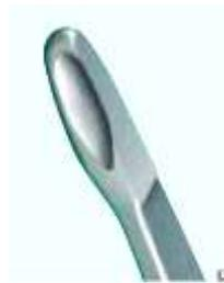
Figura 2.16. Desgaste en la lengüeta.
