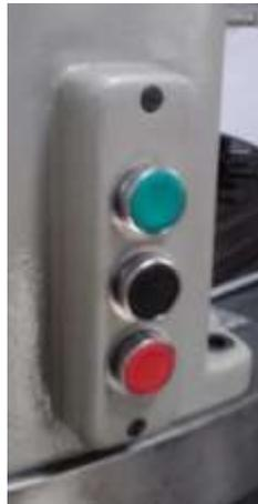
Figura 6.6. Pulsador Rasante y montaje saliente
