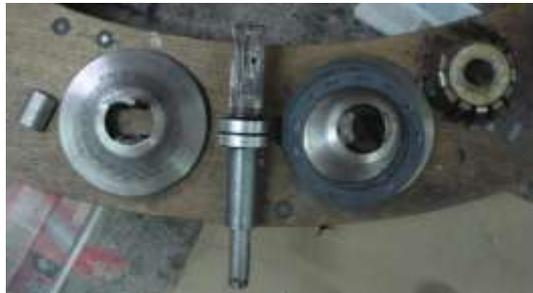
Figura 4.16. Embrague de accionamiento.
