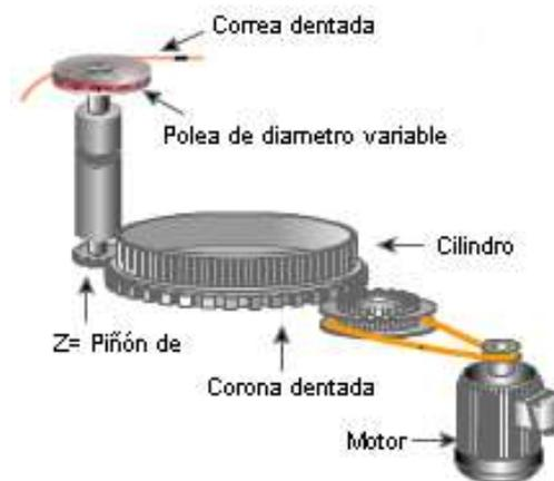
Figura 3.7. Accionamiento del alimentador positivo.
