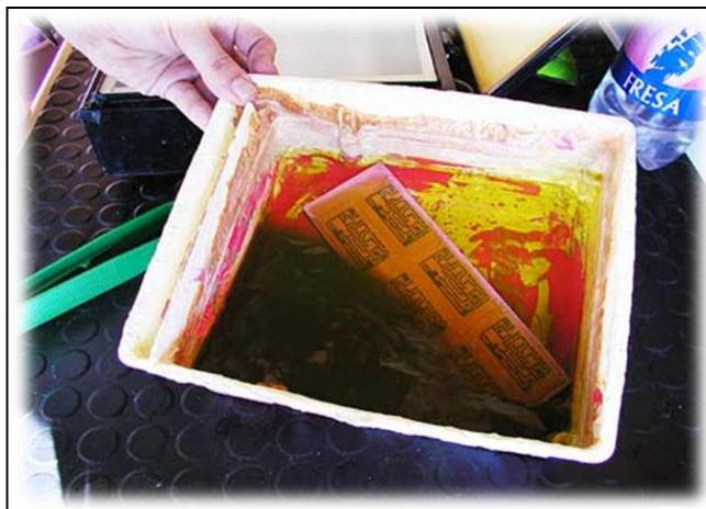
Figura 28: Percloruro y Placa
