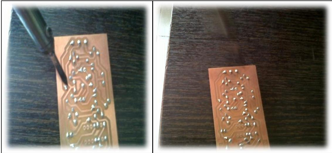
Figura 65: Soldadura de los componentes
