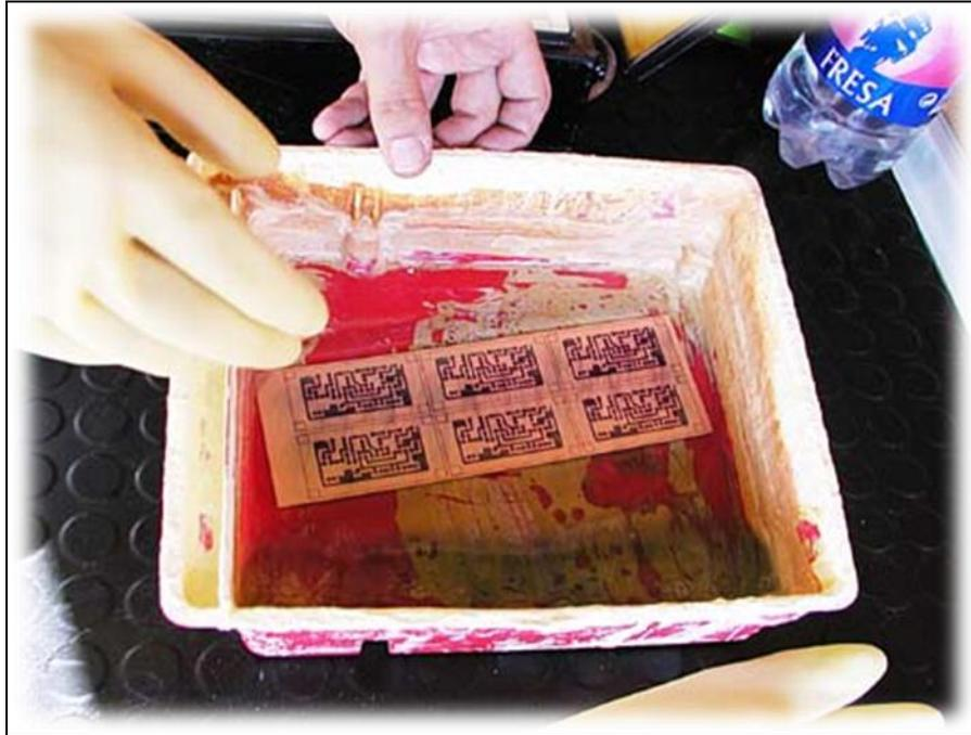
Figura 24: Imagen Revelada con el Cobre Descubierta
