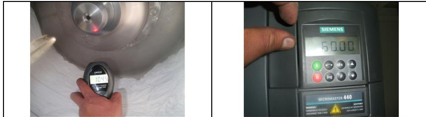
**Figura 9.11** Revoluciones máquina centrífuga
