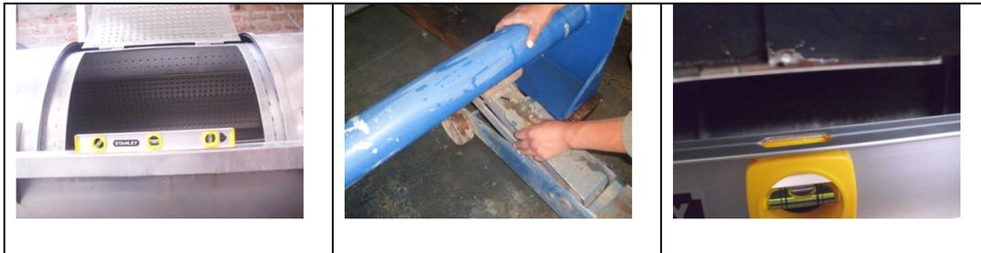
Figura N 9.1 nivelación de las máquinas
