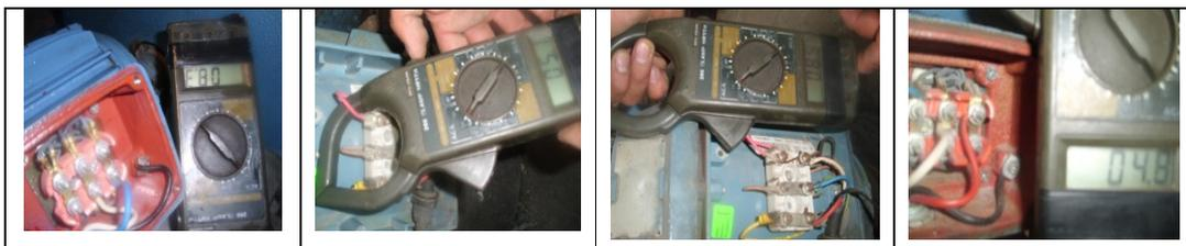
**Figura 9.15 Lecturas de amperaje máquina de secado**
