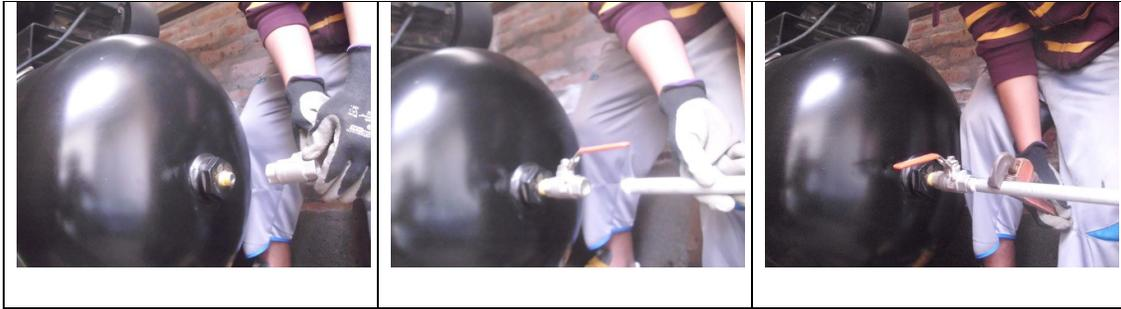
**Figura 8.15 Conexión de sistema de aire comprimido al compresor**
