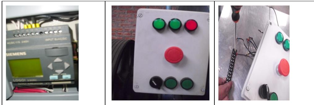
**Figura 7.3 Instalación del sistema de control máquina de lavado**
