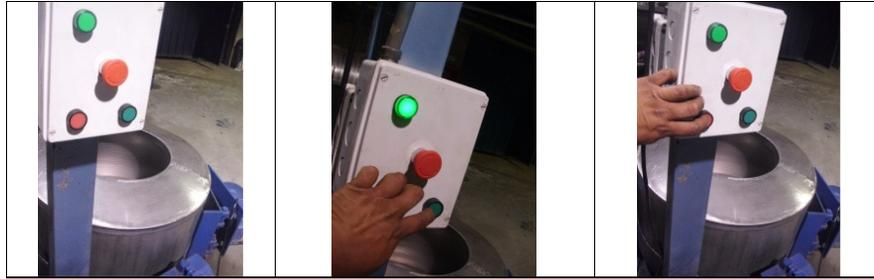
**Figura 9.9 funcionamiento del sistema manual con frenado en rampa**
