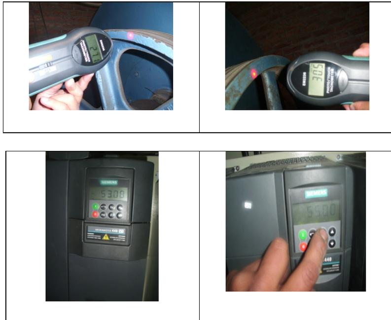
**Figura 9.6 Calibración RPM máquinas de lavado**
