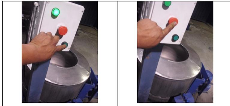
**Figura 9.10 Prueba de funcionamiento paro de emergencia**
