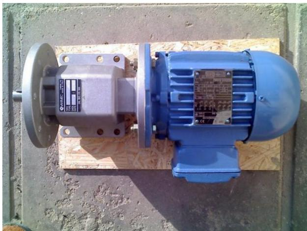
**Figura 2.5 Motorreductor acoplado a un motor**
