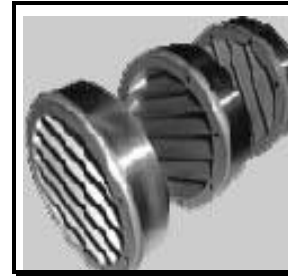
FIG.7 Punta de sensor FIG.8 Registrador digital FIG.9 Filtros salida del extrusor
