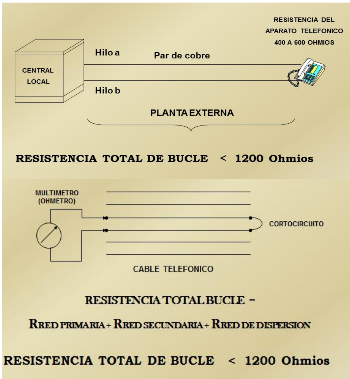
Figura 40. Medición de resistencia de bucle
