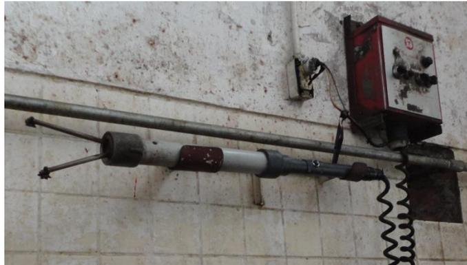
**Figura 16.8** Insensibilizador eléctrico
