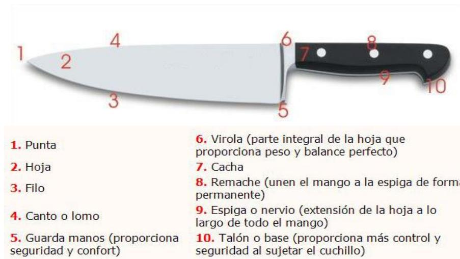
**Figura 16.1** Partes de un cuchillo
