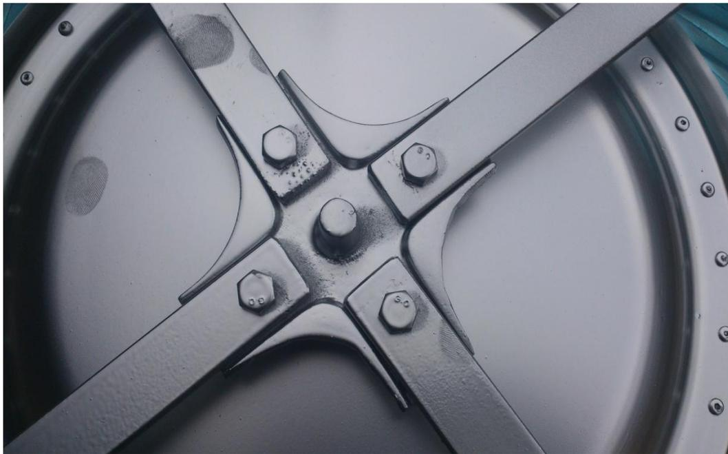
**Figura 64.** Instalación de brazos de sujeción en porta rodamiento.
