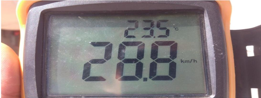
**Figura 31.** Medición de temperatura y velocidad del viento.
