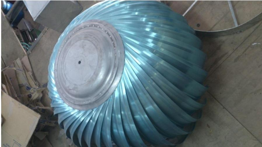
**Figura 80.** Construcción extractor eólico.
