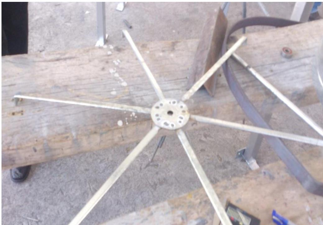
**Figura 45.** Construcción disco sujeción.
