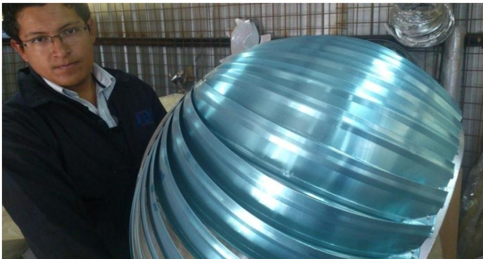
**Figura 60.** Alabes ensamblados.
