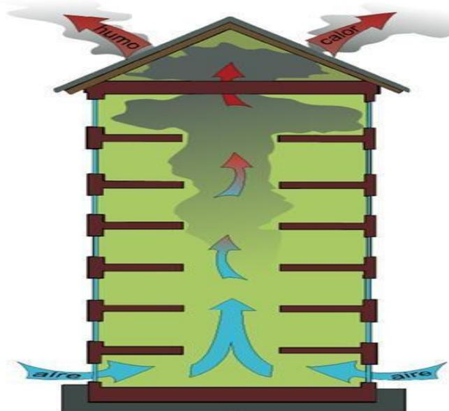
**Figura 3.** Evacuación de gases en un sistema ventilación vertical.
