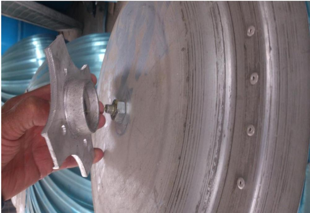
**Figura 56.** Instalación porta rodamiento.
