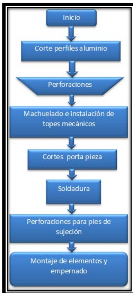
Figura 4-10 Procedimiento De Construcción Etapa De Traslado Y Sujeción
