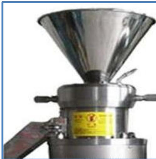
**GRÁFICO No. 36 MÁQUINA DESPULPADORA 150 kg**
