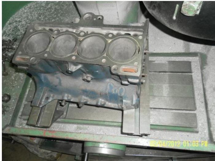
Fig.24: *Bloque de cilindros*
