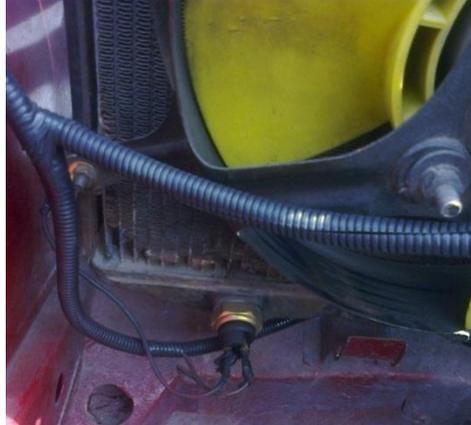
Fig. 55: *Sensor instalado del ventilador*
