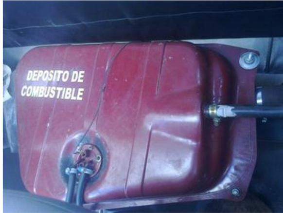
Fig. 47: Depósito de combustible y tuberías
