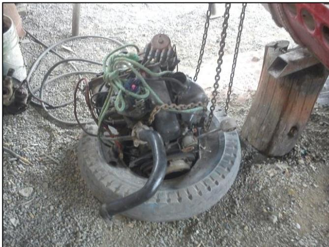
Fig.19: *Desmontaje del motor*
