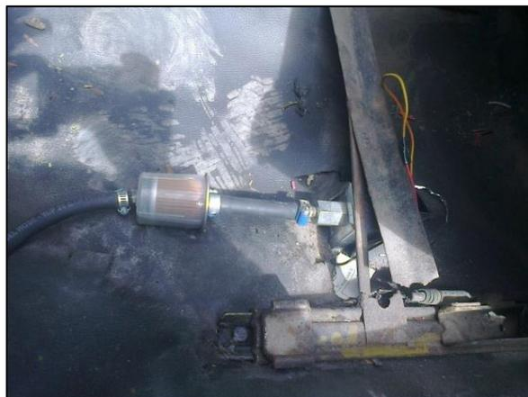
Fig. 48: Bomba y filtro de combustible
