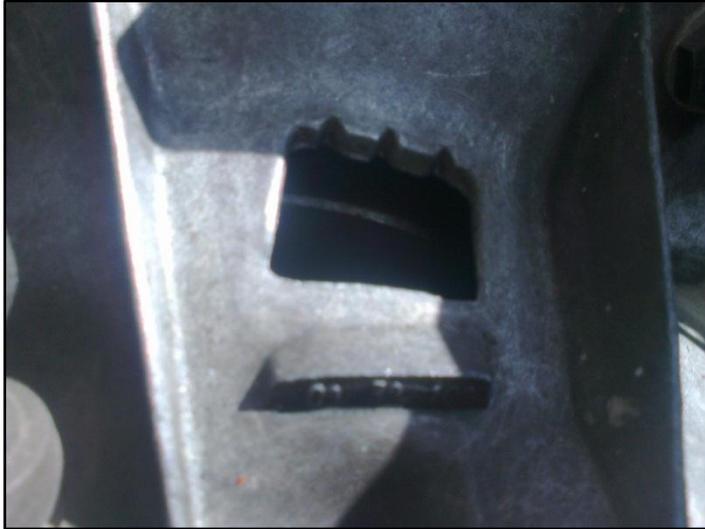
*Fig. 60: Marcas de volante y carcasa del embrague*
