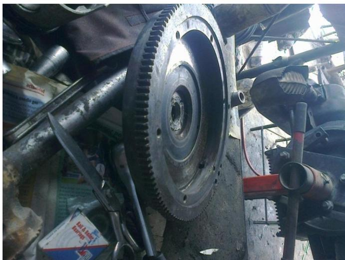
Fig. 30 *Volante del motor*
