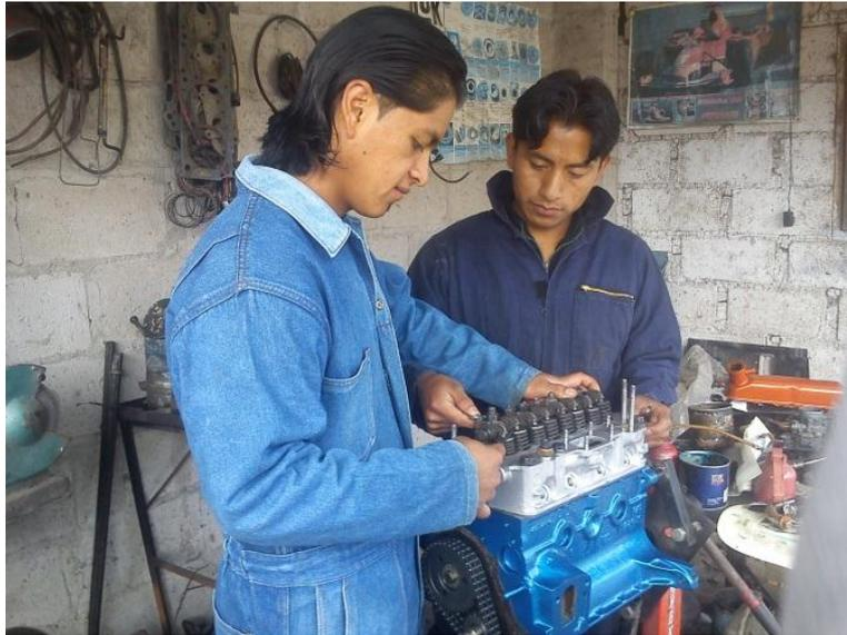
Fig.44: Calibración de válvulas en el cilindro 1
