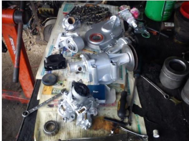
Fig. 53 Bomba de Agua y termostato
