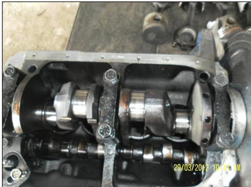
Fig. 28: Montaje del árbol de levas y Cigüeñal
