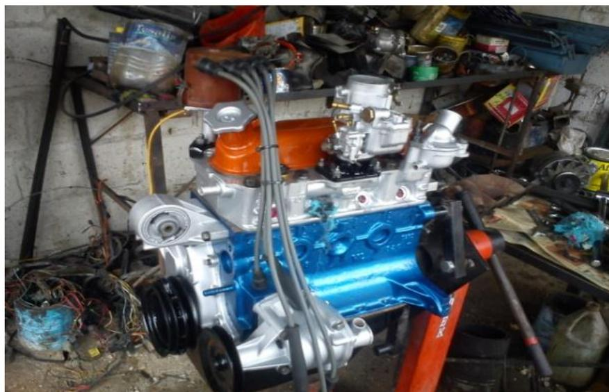
Fig. 56: *Montaje de elementos externos del motor*
