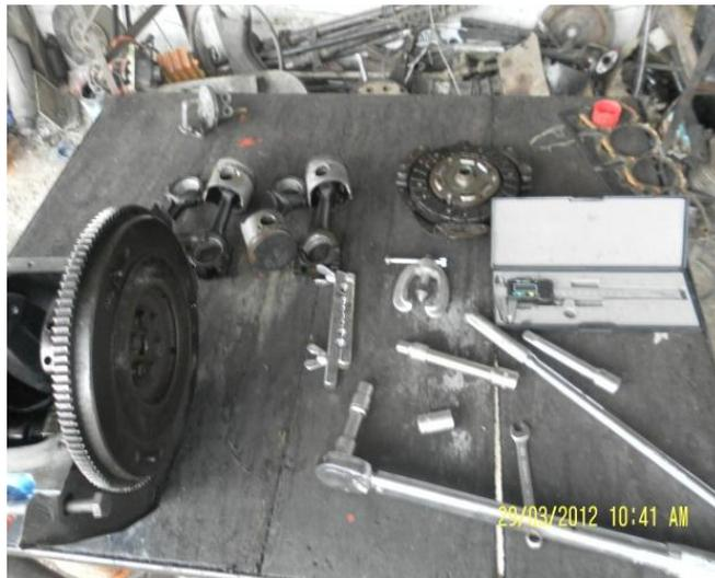
Fig. 29: *Volante Del Motor*
