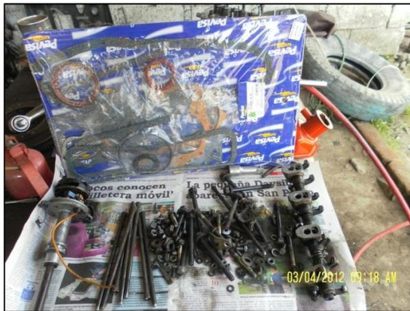
Fig.42: Empujadores, varillas y balancines
