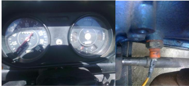
Fig. 51 *Trasmisor eléctrico de presión de aceite*
