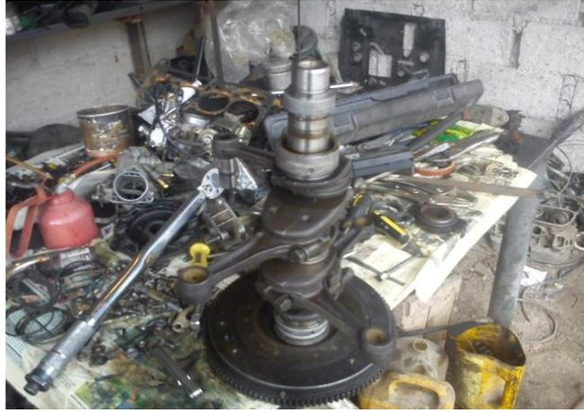
Fig. 26: *Volante del cigüeñal*
