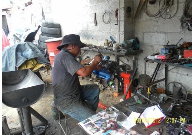
Fig. 35: *Introducción de conjunto biela -pistón en el cilindro*
