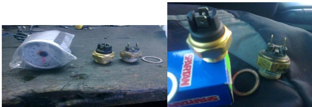
Fig. 54: Sensor del ventilador
