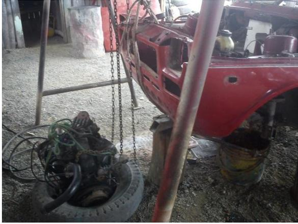
Fig.17: *Desmontaje del motor*
