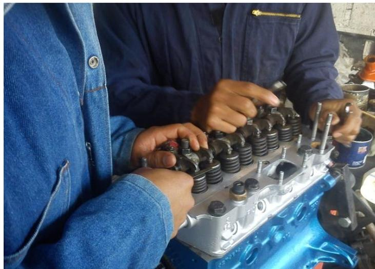
Fig.45: Calibración de válvulas en el cilindro 4
