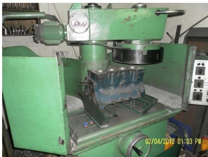
Fig.25: *Rectificación del Bloque de cilindros*
