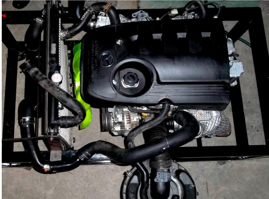
Fig. 18 Motor Mazda BT50 equipado con Turbo de Geometría variable
