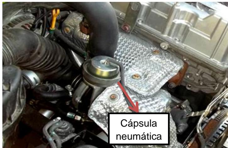
Fig. 24 Cápsula neumática del turbo de geometría variable
