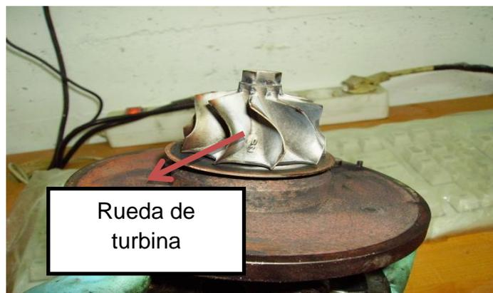
Fig. 21 Rueda de turbina del turbo de geometría variable
