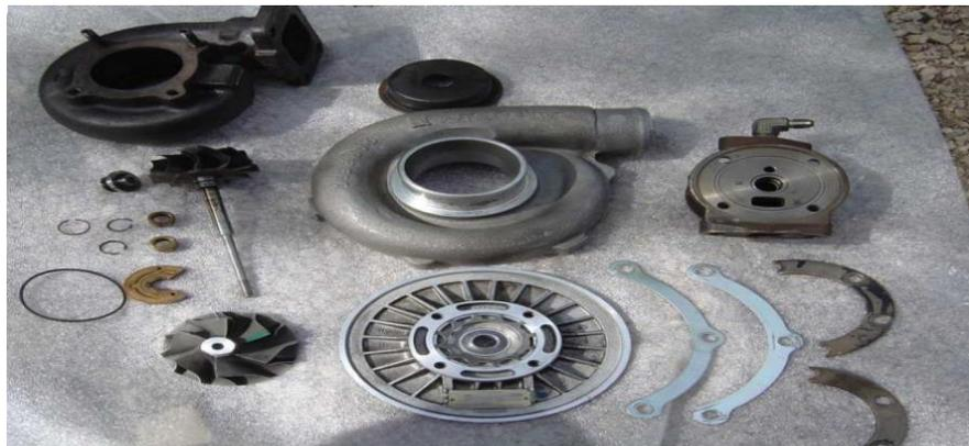
Fig. 27 Partes de un turbocompresor
