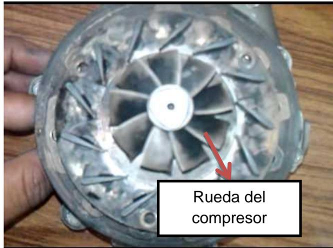
Fig. 20 Rueda del compresor del turbo de geometría variable
