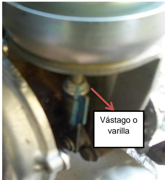
Fig. 25 Vástago o varilla de accionamiento
