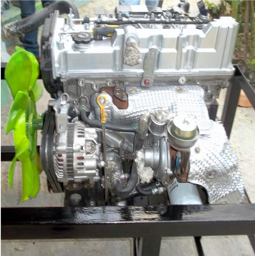
Fig. 16 Turbocompresor TGV Mazda BT50 Diésel
