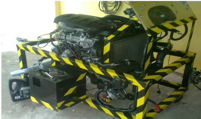
**Fig. 39** Maqueta real del Motor Mazda BT50 Diésel
