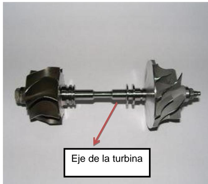
Fig. 22 Eje de la turbina del compresor TGV
