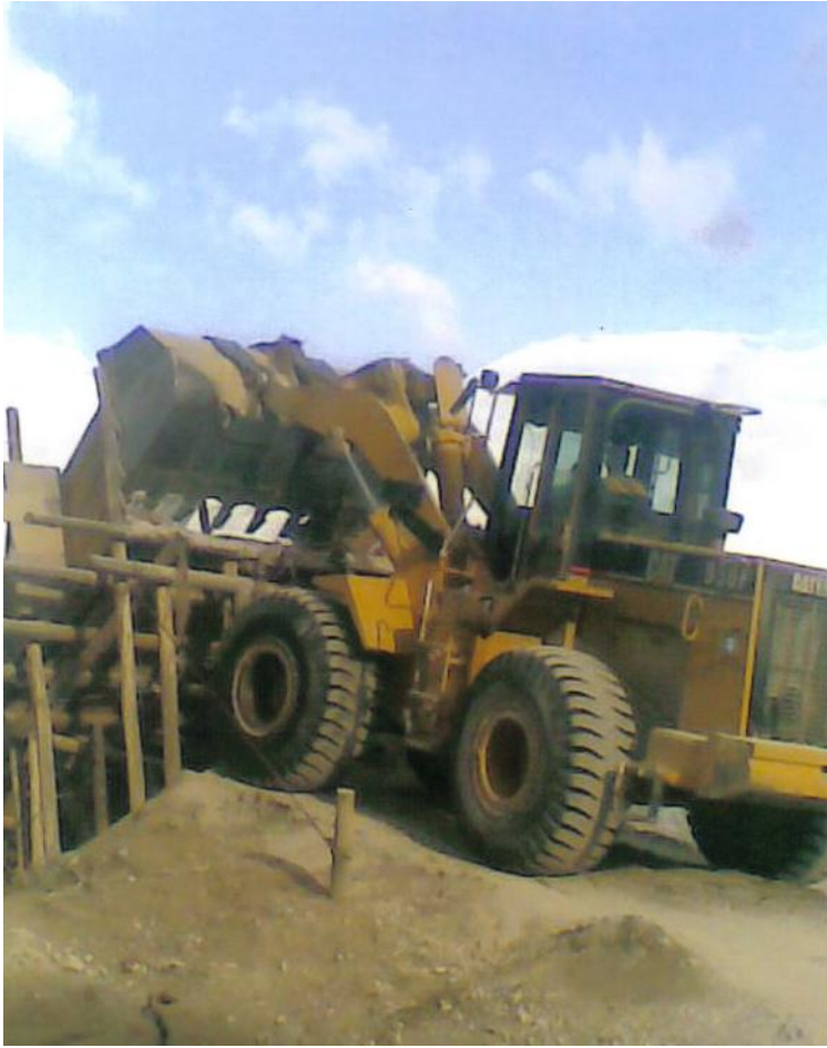
Cuadro N° 9: ABASTECIMIENTO A LA TOLVA CON LA CARGADORA ( Máquina corazón de la cantera)
