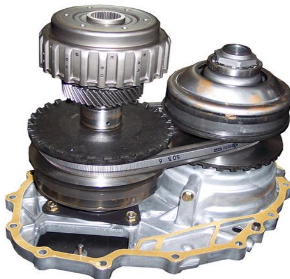
Gráfico 15.- Acoplamiento de la transmisión CVT
