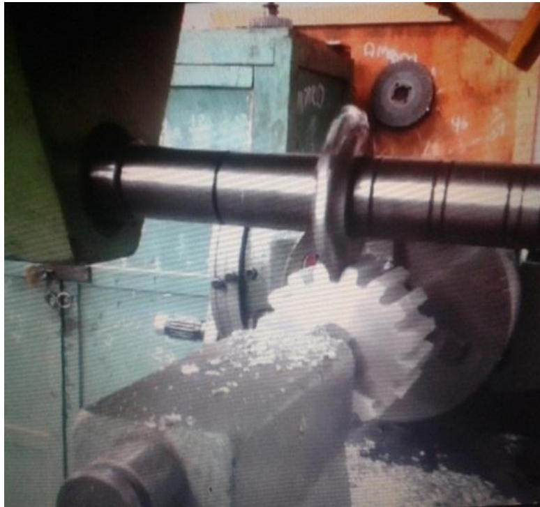
Gráfico 30.- Fresado de dientes de engranajes (satélites) Fuente: (Autores)
