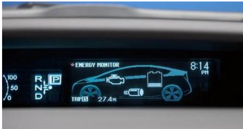
Gráfico 42.- Toyota Prius detenido con batería baja Fuente: (Autores)
