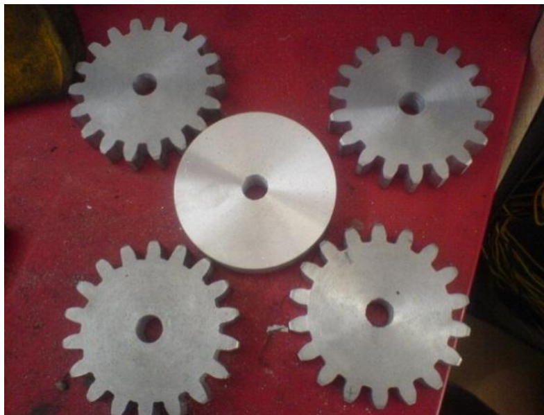
Gráfico 31.- Fresado de dientes de engranajes (satélites) Fuente: (Autores)
