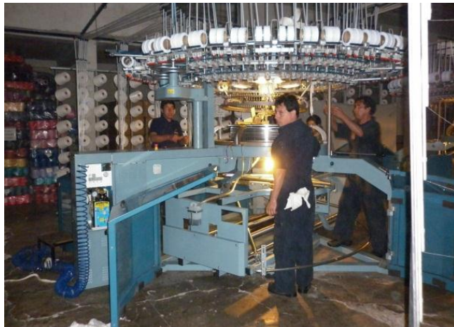
Mantenimiento Preventivo de la Maquina Mayer
