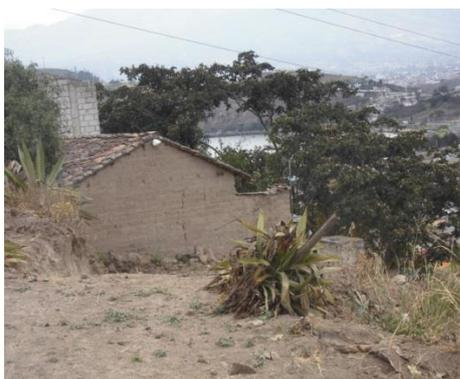
**Fotografía 25.** Edificación con vulnerabilidad alta a deslizamiento
