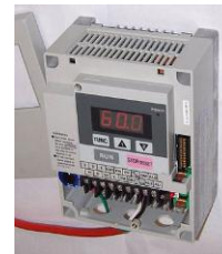
Figura 6. Variador de Frecuencia.
