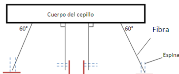
Figura 4.12 Inclinación de las fibras según el cuerpo del cepillo
