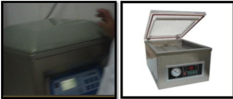
**Ilustración N° 33: Empacadora al vacío**
