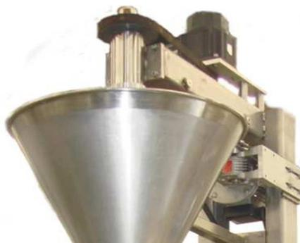
**Figura 3.3.** Gráfico Alternativa 3 (Sistema de dosificación)
