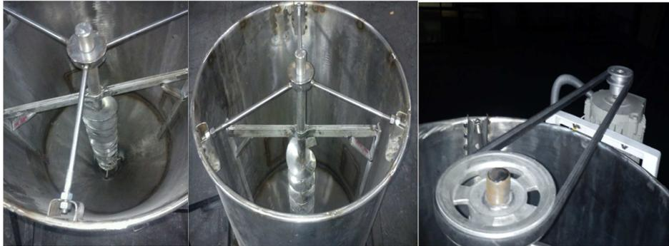
**Figura 6.36. Montaje 1 Tornillo sin fin**
