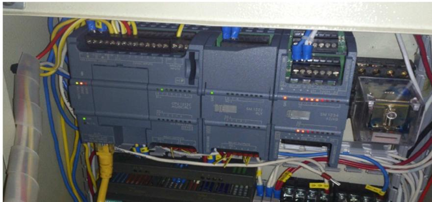
**Figura 6.39.** Montaje1 Tablero de control del PLC
