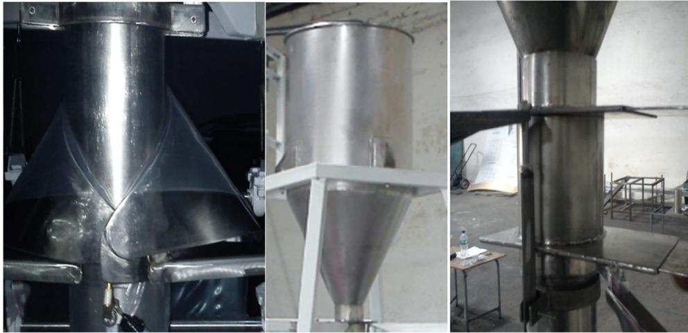
**Figura 6.13.** Construcción Tolva, Sistema de compuertas de válvulas, Sistema pesaje, Cuello formador y Tubo de distribución
