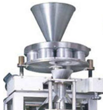
**Figura 3.1.** Gráfico Alternativa 1 (Sistema de dosificación)
