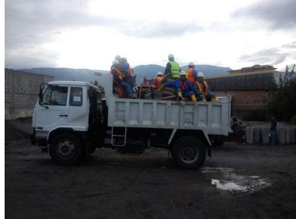
Fig.2 No se respeta normas de tránsito al momento de transportar a trabajadores
