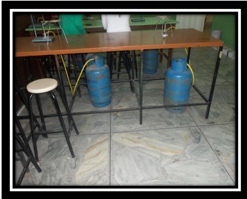
LABORATORIO, RIESGO DE EXPLOSIÓN
