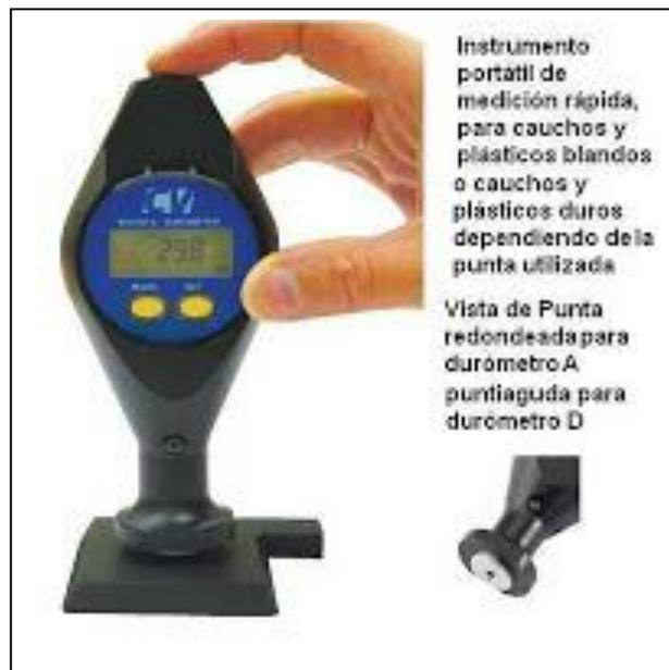
**Figura 1.16** Instrumento portátil de medición rápida cauchos y plásticos blandos y duros<sup>17</sup>.
