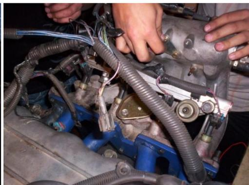
**Fig. 40 Instalación del Cableado**
