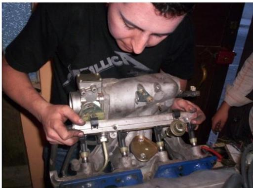
Fig. 29 Instalación de Inyectores
