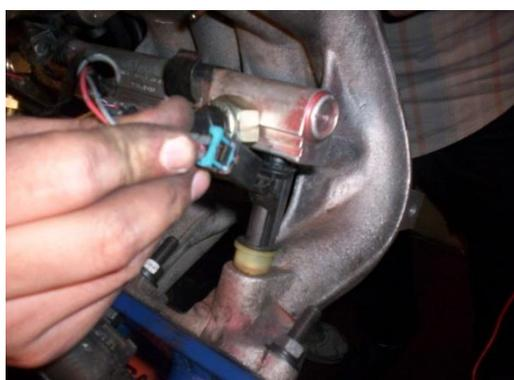
**Fig. 41 Instalación de Conectores**
