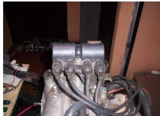
Fig. 36 Bobina de Encendido
