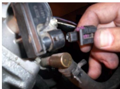
**Fig. 42 Instalación de Conectores**
