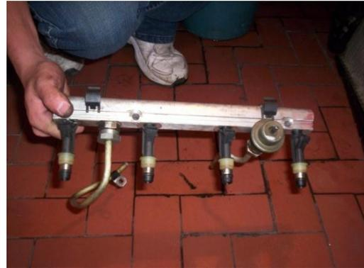
Fig. 28 Riel con Inyectores
