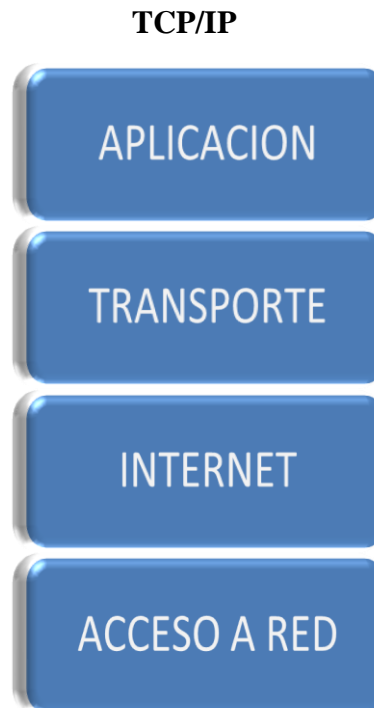
Figura 6. Capas del Modelo TCP/IP
