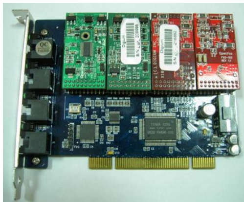
Figura 60 Tarjeta Open Vox y Módulos FXO, FXS
