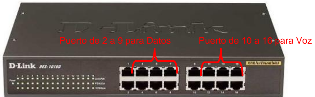
Figura 20 Distribución de Puertos Switch
