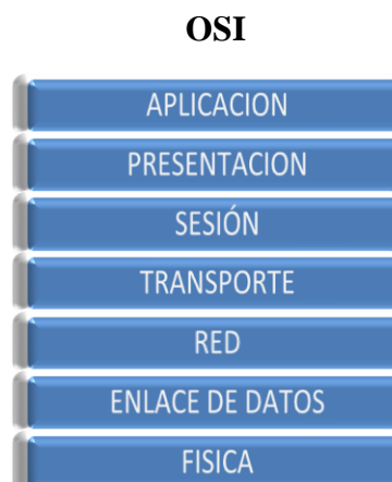
Figura 4. Capas del Modelo OSI
