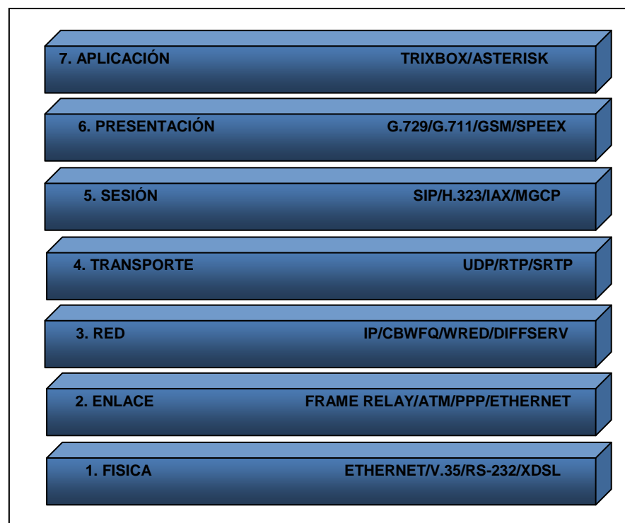
Figura 14. Referencia de Protocolo VoIP al Modelo Fuente:
