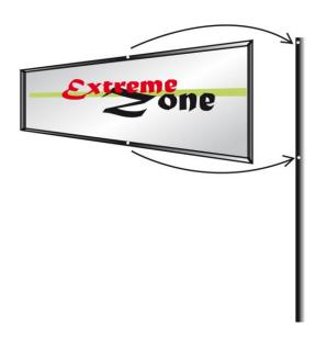
6) Finalmente lo fijamos al suelo, realizando una excavación de 50cm de profundidad en el piso, para implantar el pie del poste del rótulo, sellándolo con concreto.
