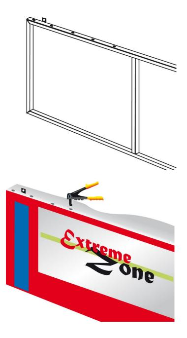
4) Señalamos los puntos exactos de perforación de las platinas de la estructura en la pared o superficie en donde se lo va a colocar, la perforamos a la medida de lo tacos Fisher número 10 y atornillamos.
