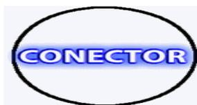
Este es utilizado para enlazar dos partes cualesquiera de un diagrama a través de un conector de salida y un conector de entrada. Esta forma un enlace en la misma página del diagrama.
