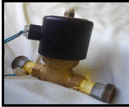
Figura 26. Electroválvula de Agua
