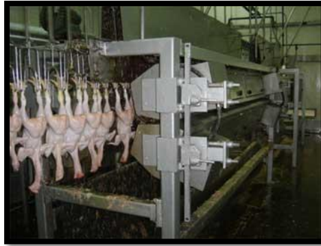
Figura 7. Escaldado por Aire Húmedo
