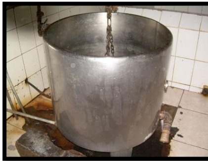
Figura 41. Tanque doble fondo de Escaldado
