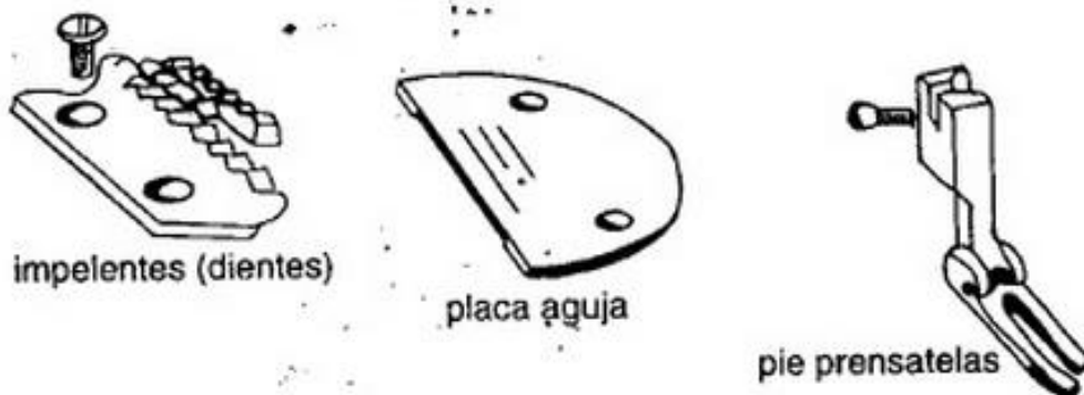
Fig. 24: Piezas que trabajan en el sistema de alimentación
