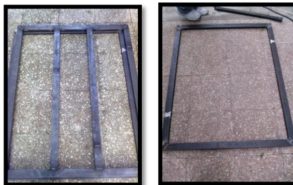
Figura 4. 1 Base superior e inferior después de soldar.
