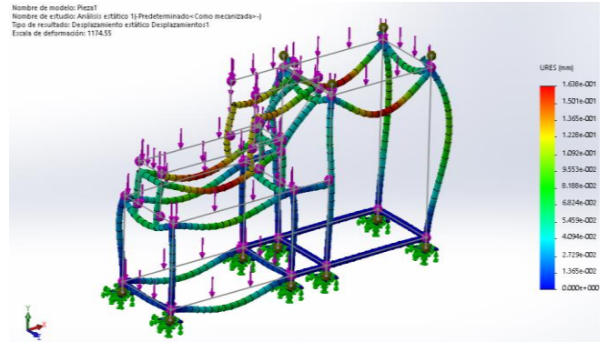
Figura 6. Desplazamiento estático de la estructura de la máquina
