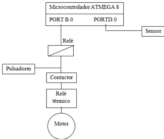
**Figure 11** Diagrama eléctrico
