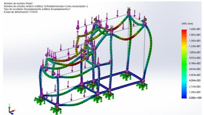
**Figure 6.** Desplazamiento estático de la estructura de la máquina
