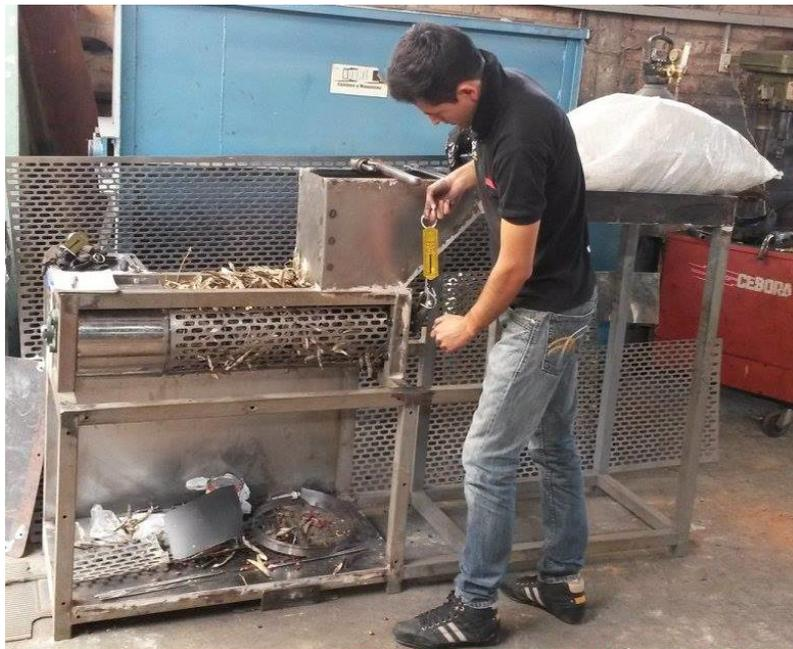
**Fotografía 5** Cálculo del torque máximo
