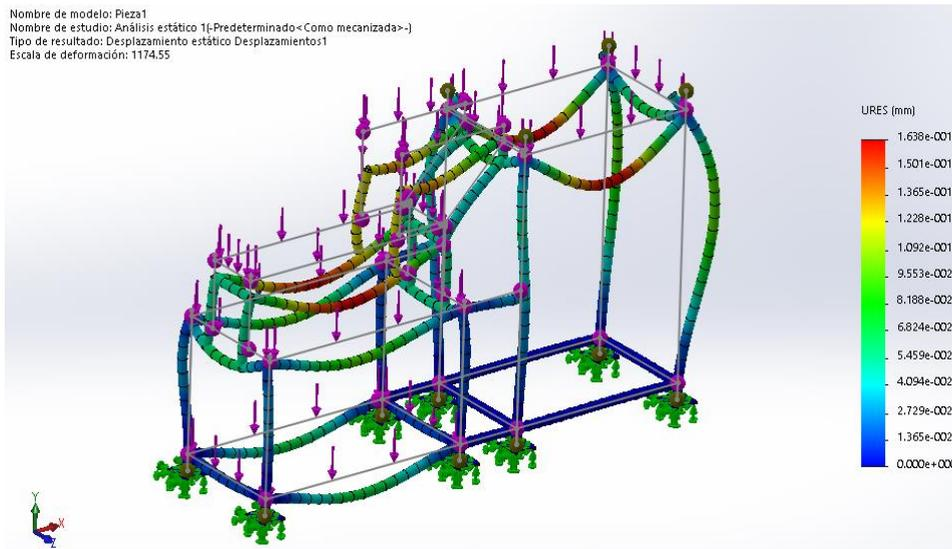
**Figura 3. 24** Desplazamiento estático de la estructura de la máquina
