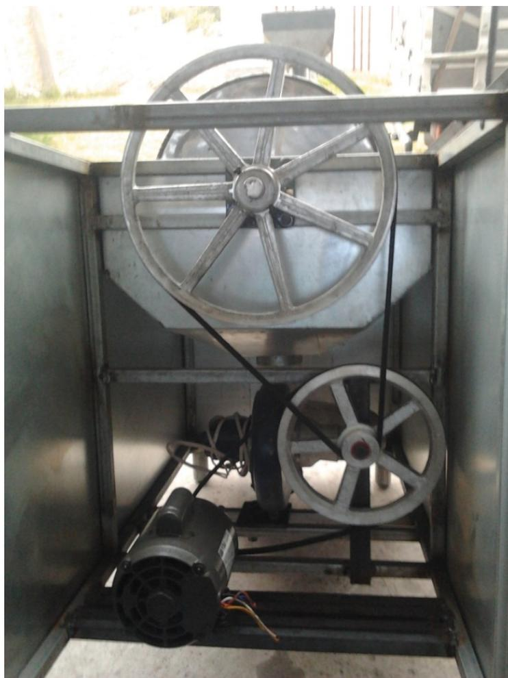
Figura 4.11: sistema de poleas y bandas.<sup>122</sup>
