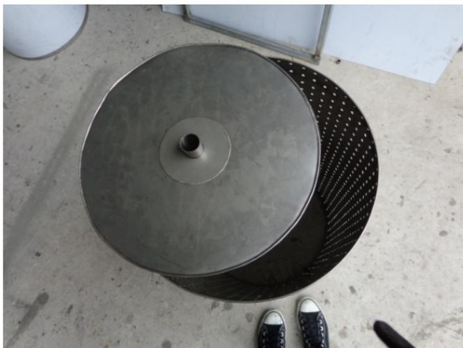
Figura 4.3: Tapa lateral que sujeta el cilindro con el eje.<sup>113</sup>
