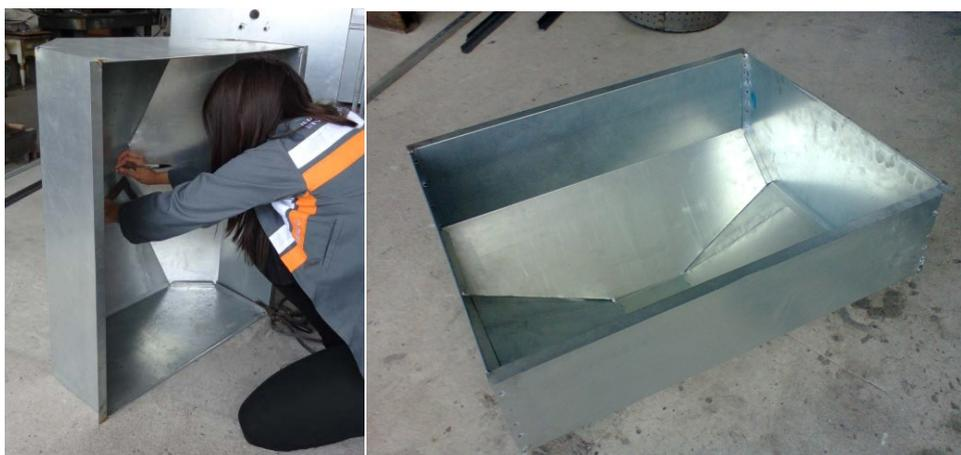
Figura 4.6: Tolva de recolección de cascara antes del montaje.<sup>116</sup>
