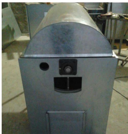
Figura 4.8: Estructura recubierta con tol galvanizado.<sup>118</sup>
