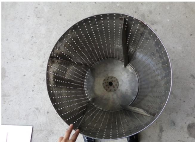
Figura 4.3: Vista de las patetas soldadas en el cilindro.<sup>112</sup>
