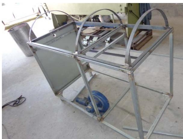
Figura 4.7: Esqueleto de la estructura antes de ser recubierta.<sup>117</sup>
