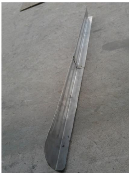
Figura 4.2: Una de las paletas antes de ser soldada al cilindro.<sup>111</sup>
