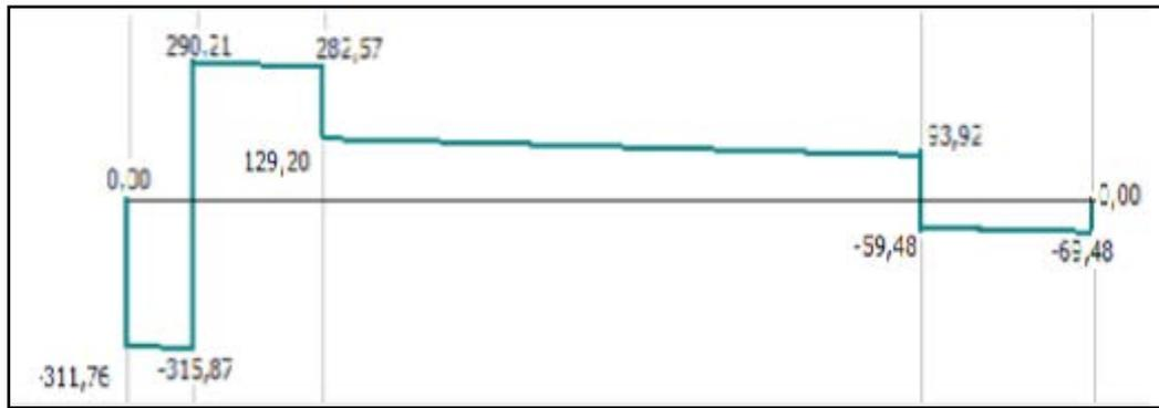
Figura 3.10: Diagrama de fuerza cortante en el eje.<sup>69</sup>
