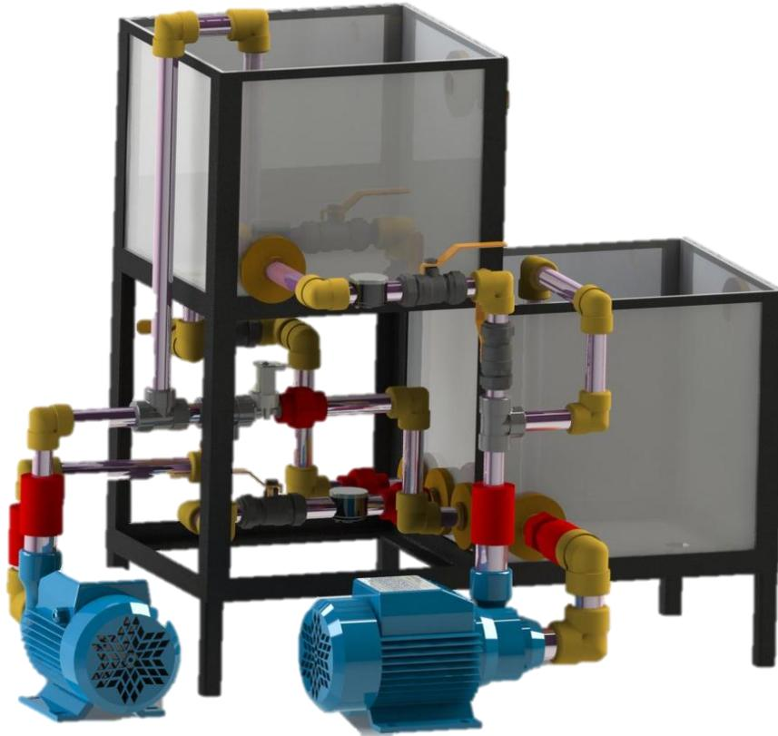
La Planta de Nivel de Agua es un sistema compuesto por un circuito hidráulico y la instrumentación necesaria para efectuar el control del nivel de agua en uno de los tanques del sistema.
