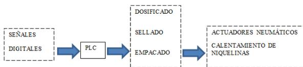
**Figura 9. Diagrama de bloques del sistema general**
