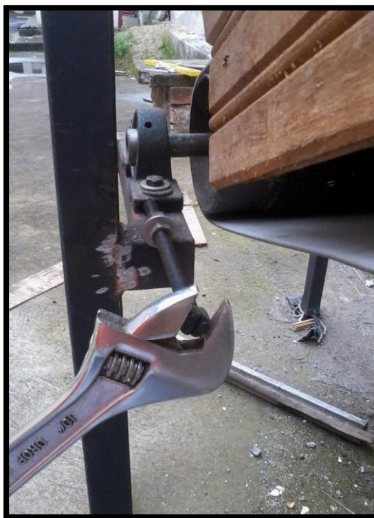
Figura 36. Sistema de tensión de la banda.
