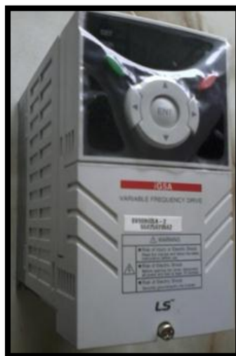
Figura 21. Variador de frecuencia LS – IG5A.
