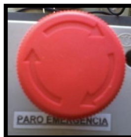
Figura 49. Paro de emergencia.
