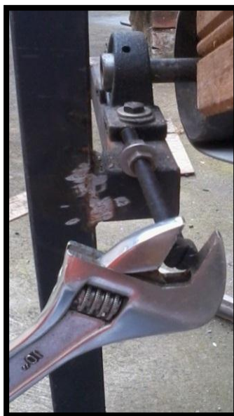
Figura 17. Sistema de tensión de la banda.
