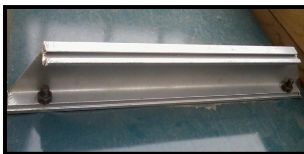
Figura 34: Canjilón de aluminio adherido a la banda
