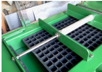
Figura 4. Cilindro neumático para la apertura y cierre de la boca de las tolvas
