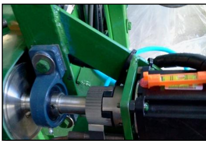
Figura 30. Acople de transmisión de movimiento del motor a la banda transportadora
