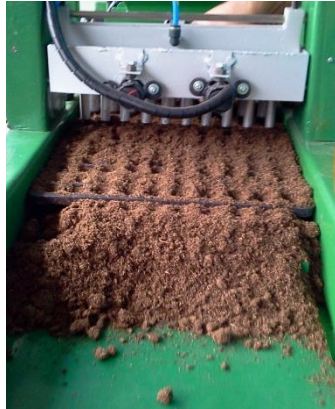
Figura 29. Acumulación de turba en la banda transportadora
