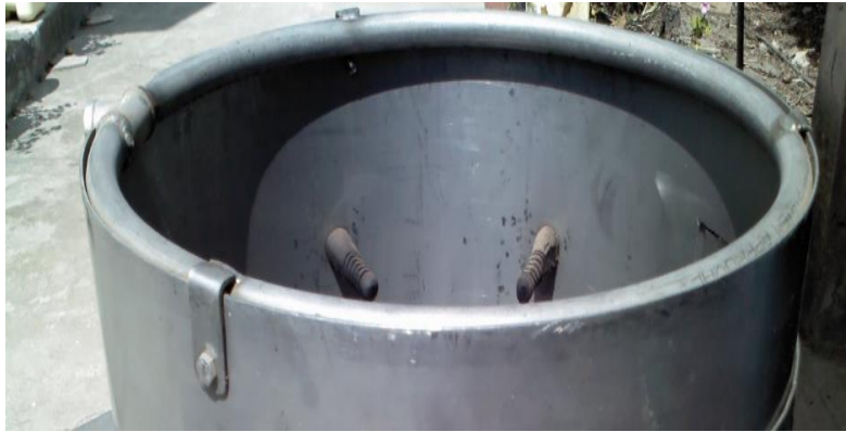
Figura 21. Tubo de suministro de agua montado en la olla de pelado.
