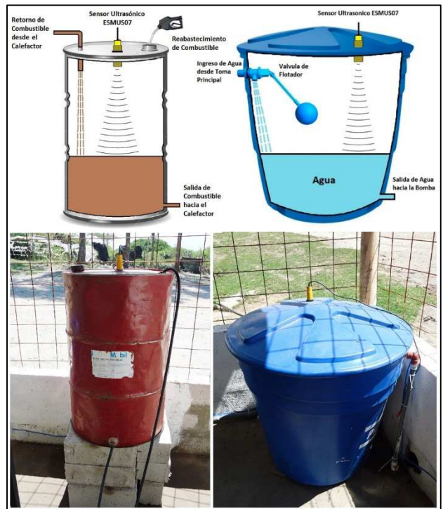
Figura 16.-Sensores de Nivel de Líquidos
