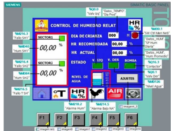
Figura 25.-Pantalla Sistema de Control de Humedad
