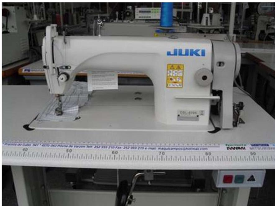
Ilustración 15 Máquina Recta o Plana<sup>34</sup>
