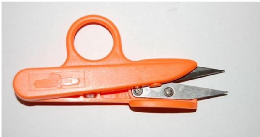
Ilustración 17 Limpiador o cuchilla para cortar hilos<sup>36</sup>
