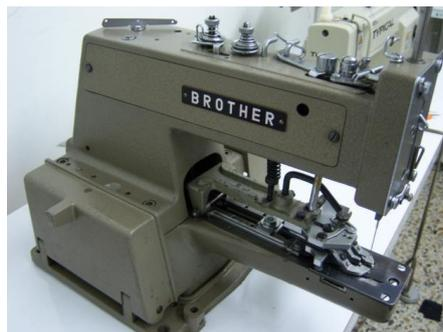
**Figura 4.30.** Máquina Botonadora.
