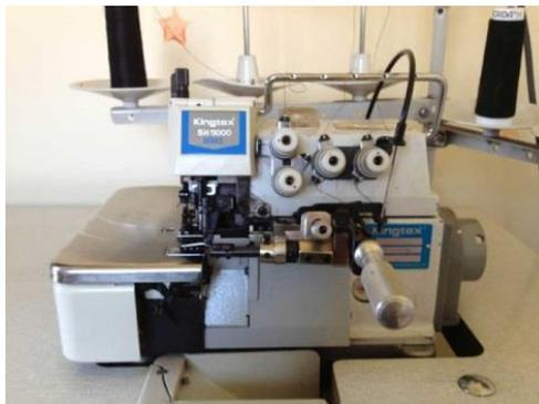
**Figura 4.28.** Máquina Rematadora.
