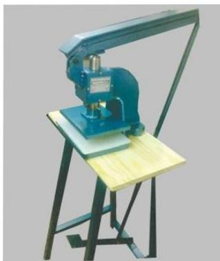
**Figura 4.31.** Máquina troqueladora.
