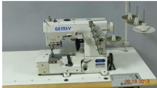
**Figura 4.26.** Máquina Recubridora.
