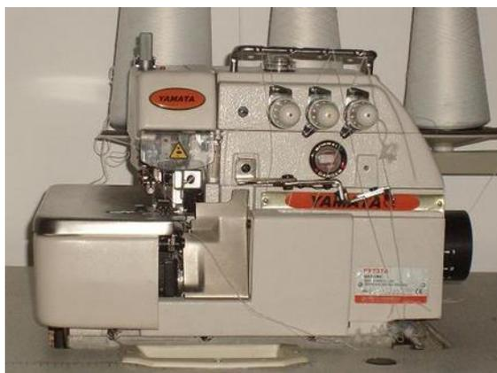
Figura 4.24. Máquina industrial overlock tres hilos.
