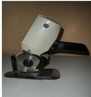
**Figura 4.21.** Cortadora de disco.
