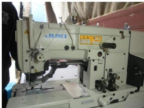
**Figura 4.29.** Máquina Ojaladora.
