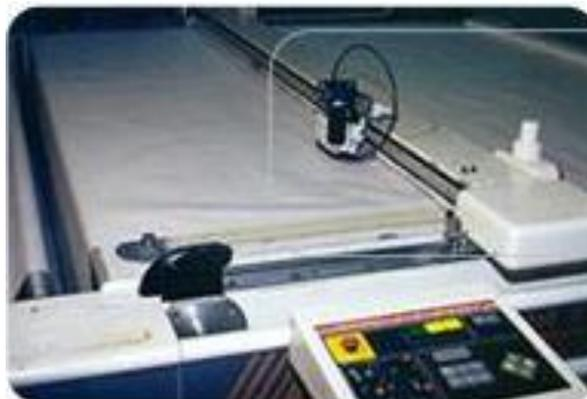
**Figura 2.1.** Cortadora de tela a laser.
