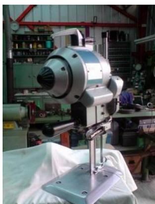
Figura 4.20. Cortadora de cuchilla vertical.
