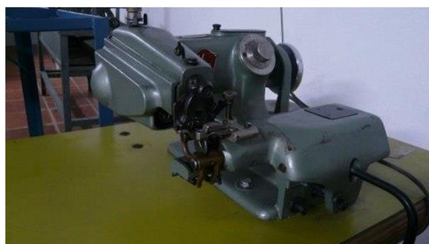
**Figura 4.27.** Dobladora de puntada invisible.
