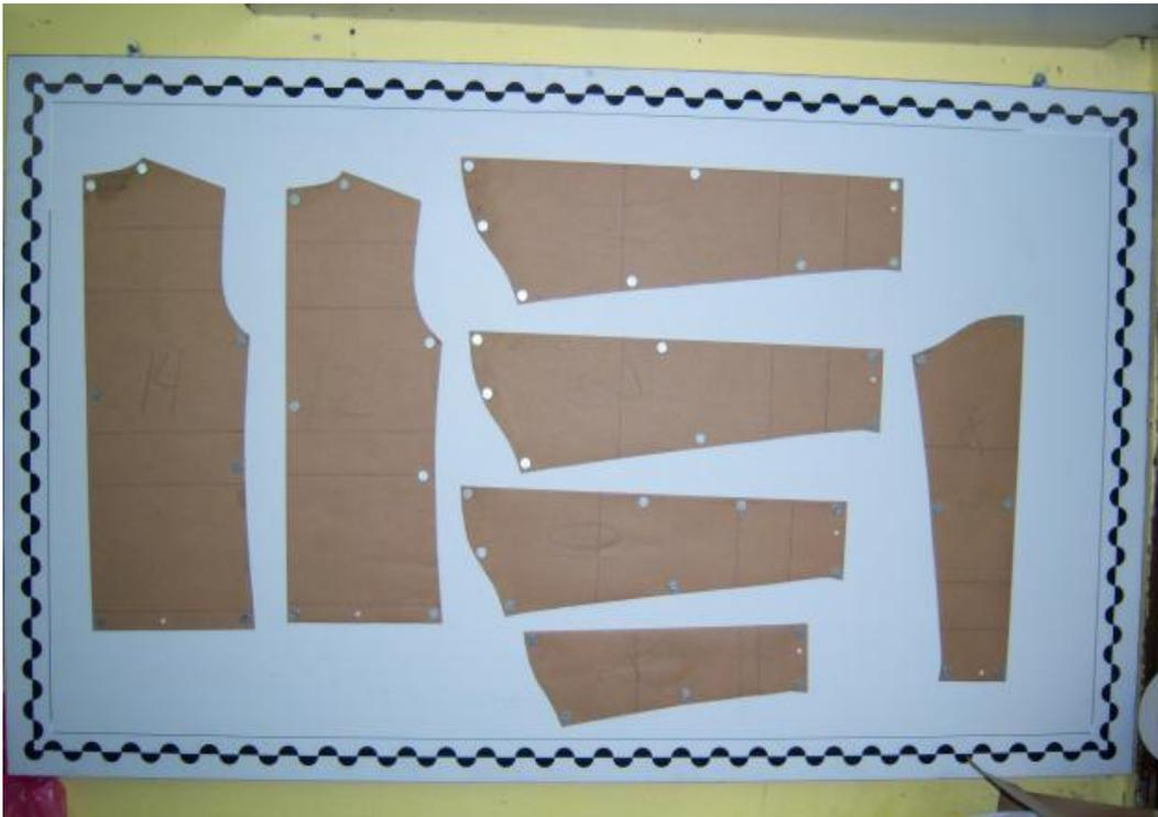
➤ **Tendido y colocación de moldes.**
