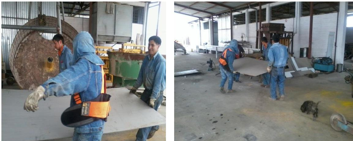
***Ilustración2-10: Ninguna precaución al manipular cargas de peso considerables.***
