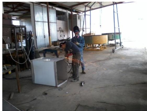
***Ilustración 2-17: Equipos de Protección Personal en mal estado.***
