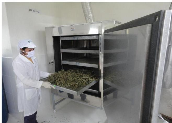
Fotografía 7. Secador de bandejas 2009-10-22
