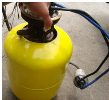
Depósito y filtro de combustible del modelo didáctico
