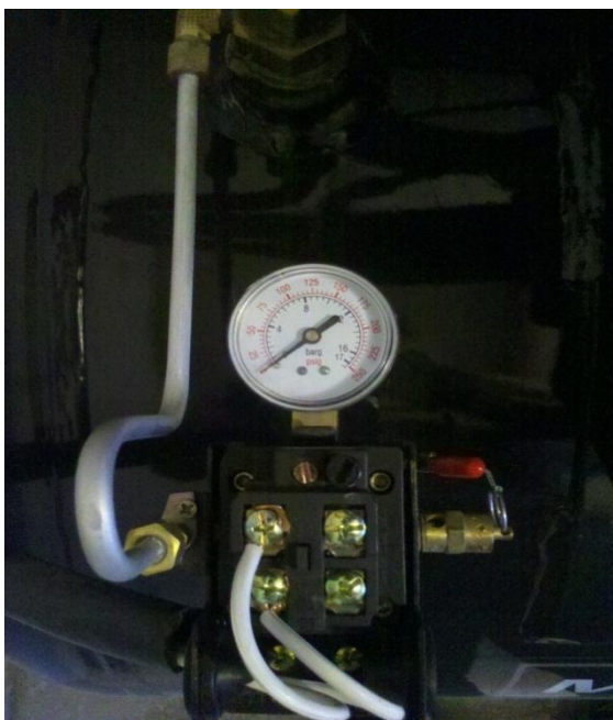
Figura 49: Regulador de presión y válvula de alivio.
