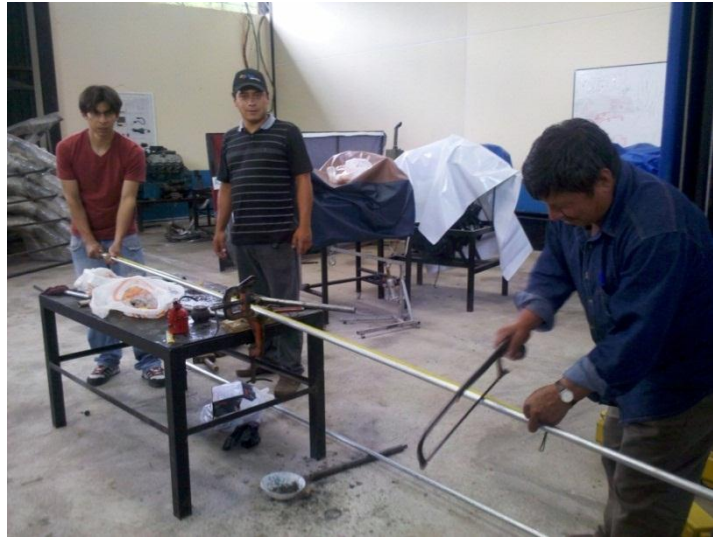
Figura26: Corte de tubería galvanizada. Fuente. Bastidas M; Pinchao H. (2012)
