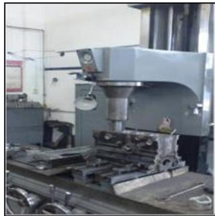
Fig.71: Proceso de rectificado.
