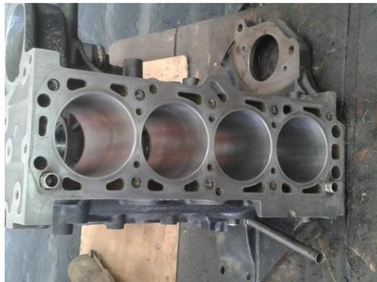
Fig.65: Block vacío del motor.
