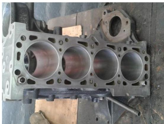
Fig.64: Block vacío del motor.
