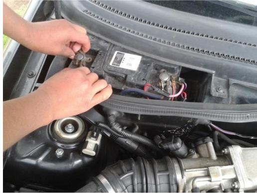
Fig. 50: Desconexión y Desmontaje de la Batería.
