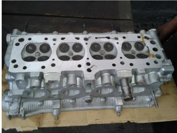
Fig. 58: Desmontaje del cabezote.
