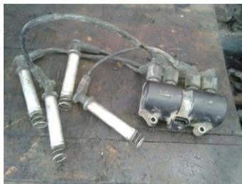
Fig.51: Desmontaje de Bobina y Cables de Bujías Encendido.
