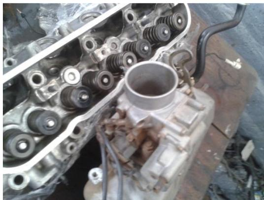
Fig.57: Desmontaje de la tapa de válvulas.
