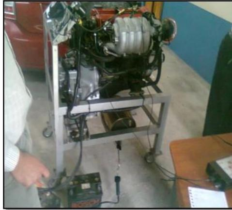
Figura.79: Medición de gases de escape.
