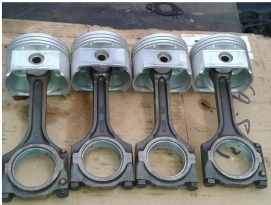
Fig.69: Pistones nuevos sobre medidos en 1.5 mm a utilizar.
