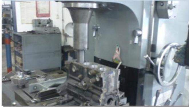
Fig.72: Proceso de rectificado.
