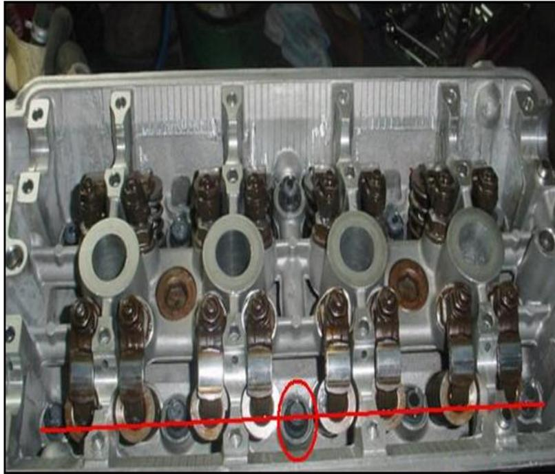
Fig. 29: Perno inferior del medio en una culata en el cabezote.
