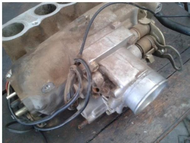
Fig.52: Desmontaje del Sistema de Alimentación.
