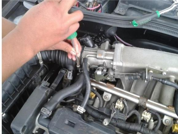
Fig.54: Desmontaje del Sistema de Admisión.
